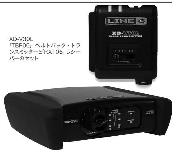
XD-V30L 「TBP06」ベルトバック・トランスミッターと「RXT06」レシーバーのセット
