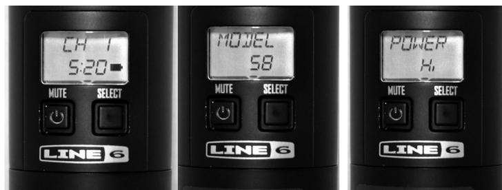
「THH12」の作動可能時間表示/マイクロフォン・モデル表示/出力表示
