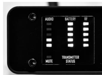
「PX212」レシーバーのLEDは、RFレベル、トランスミッターのバッテリー残量、オーディオレベル、ミュートを表示
