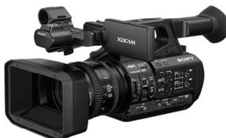
新開発1/3型 3CMOSを搭載し4K60p収録に対応 光学25倍ズームが可能なハンディカムコーダー
