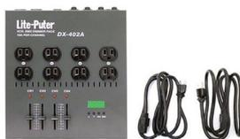
入力電源は15A 2系統。各2chの出力、合計4chの制御が可能な調光ユニット。本体搭載のフェーダーで調光制御は手軽。DMXコントローラで遠隔操作も可。
