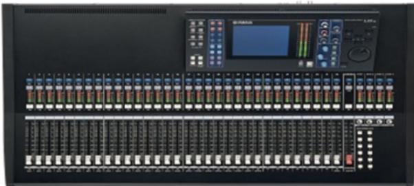
インプット、アウトプットが豊富。これ1台でバンド音響も対応可。GEQ、エフェクター、BGM用プレーヤー、記録用レコーダー多彩な機能が搭載。Input32ch Output16ch
