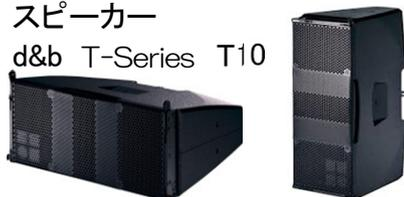
ライン・アレイとして、高指向性のポイントソース・ラウドスピーカーとして使用でき優れたスピーカー。スタンド立て、グランドスタック、フライングなど用途多彩。パワー・ハンドリング能力, LF(RMS/peak 10 ms)200/800W、定格インピーダンス16Ω, 重量11kg
